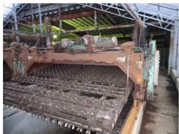
腐食が進んだ鉄骨の柱（左側）と攪拌機（右側）
