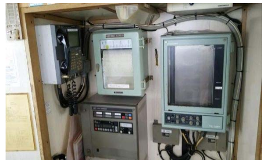
型式が古く修理不能となっている、試験調査船最上丸の観測機器など
