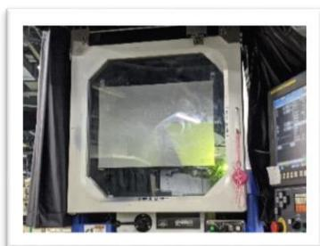
私は開発技術部に所属していますが、今は助っ人として P G (プロファイルグラインダー) 部門で特殊切削工具の加工をしています。モノに光を当てて 20~50 倍に拡大して、それを見ながら加工するもので、基本的に図面との誤差が 100 分の数ミリ以内を狙った精度の高い作業となります。難しいときには数ミクロン (1 ミクロン = 0.001mm) 単位を狙ったり……。
