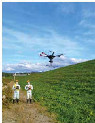
UAVによる空中写真測量
