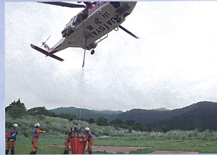
消火バケット取付作業
