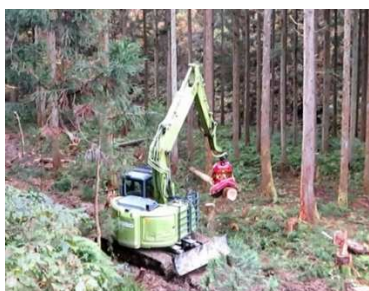
画像6 高性能林業機械（ハーベスタ）による伐採状況（鶴岡市温海地域 R3. 10）
