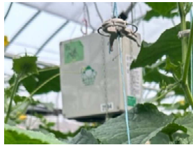
○環境モニタリング機器 (温湿度、CO 2 濃度計測)
