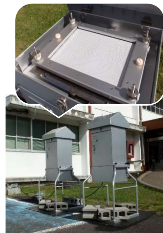
ハイポリウムエアサンプラーによる大気粉じんの採取
