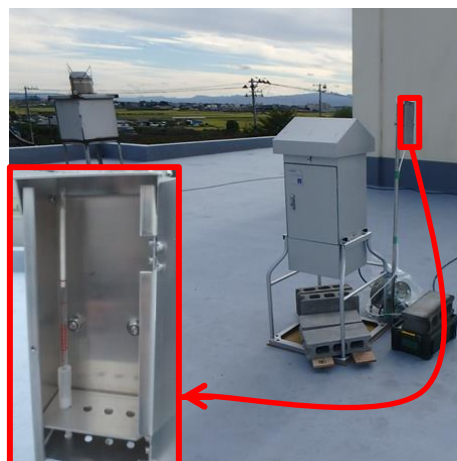
（拡大部分は化学物質を集める採取管） 大気を調査する機器
