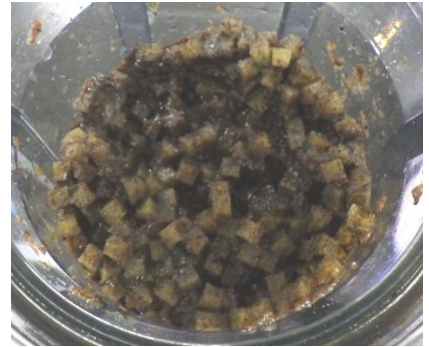
図 2 汚泥と担体の混合物
