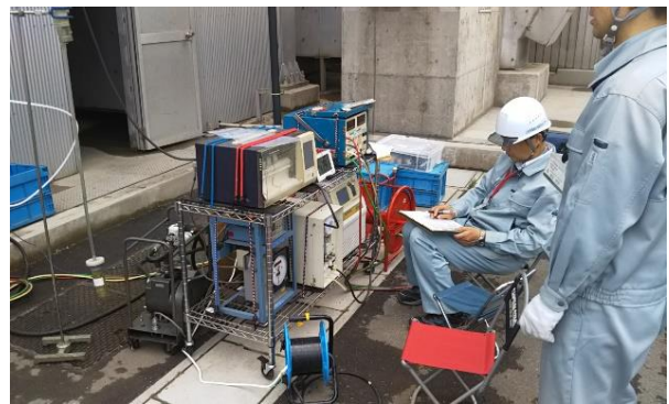
図1 排ガス採取の様子
