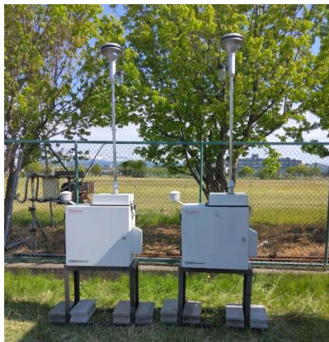
図2 PM2.5試料採取の様子
