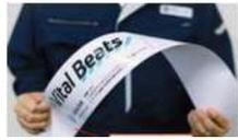
インクジェット技術によって製造されたフレキシブルなセンサー
