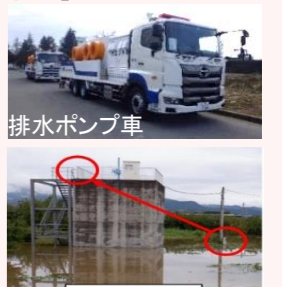
排水ポンプ車
