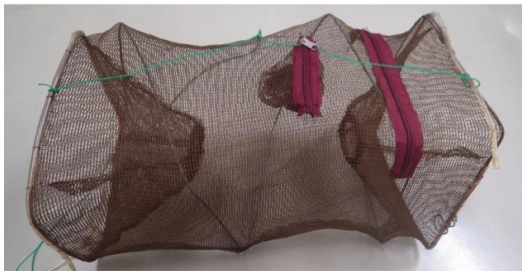
図4 用いた小型トラップ 上部チャック内の袋網に魚類内臓・筋肉片を入れて使用
