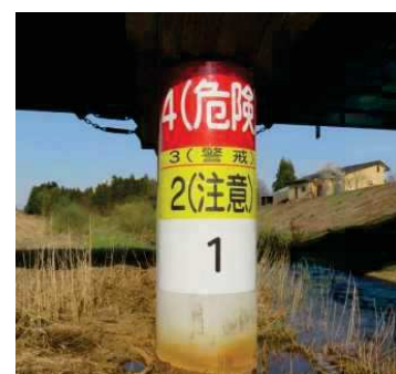
量水標設置状況（拡大）
