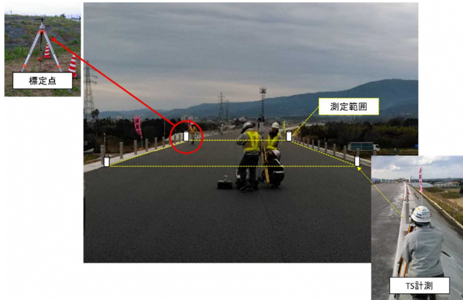
図4-3 TLSと標定点の配置(例)
