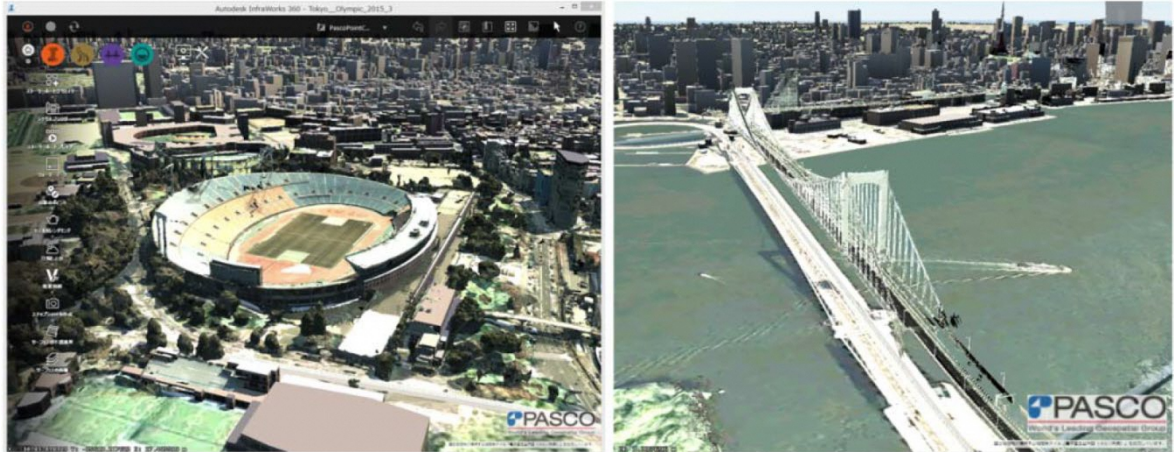
図 32 オブリークカメラ他を組み合わせた 3 次元鳥瞰図
