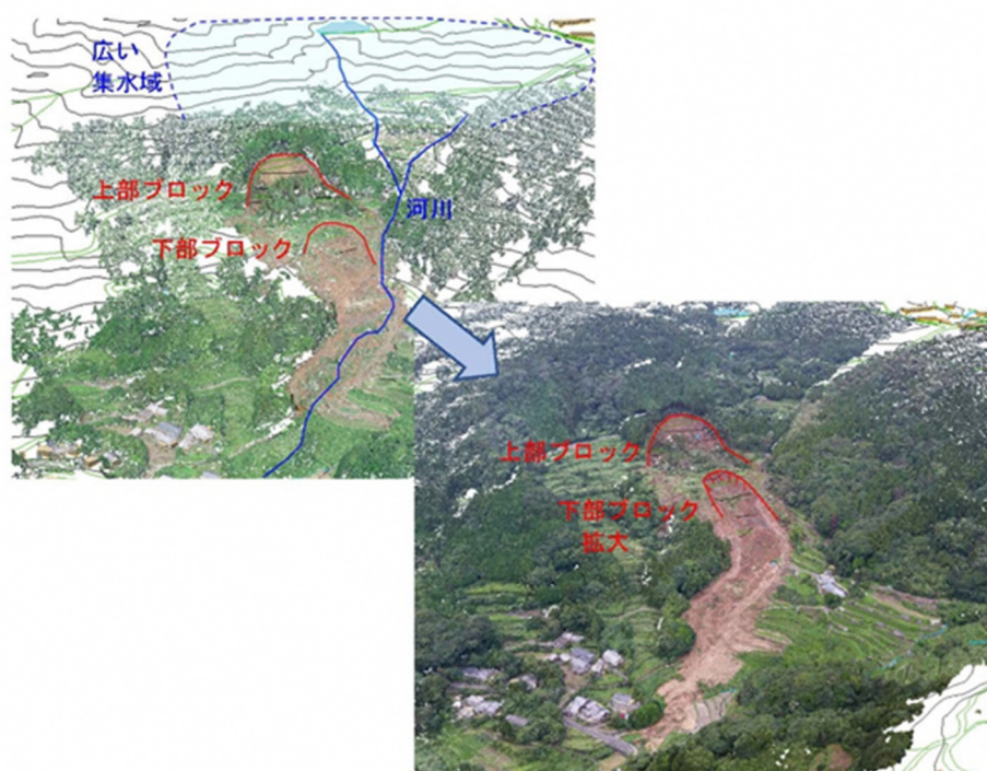
図 13 災害発生直後の地すべり災害対応に活用する BIM/CIM モデルの例（詳細度：100）
