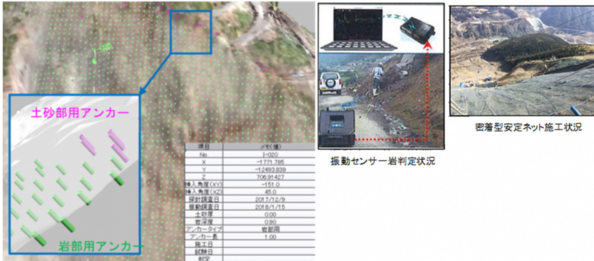
図 57 3D モデルによる施工管理システムの例
