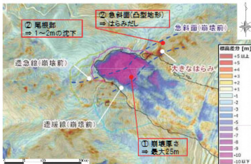
図 50 頭部排土および斜面の土砂移動状況の把握、差分解析図の例
