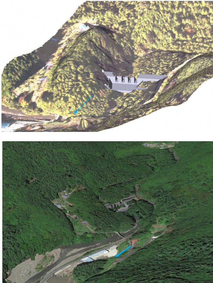
図 17 施設設計検討において活用するBIM/CIMモデルの例(1)(詳細度:300)
