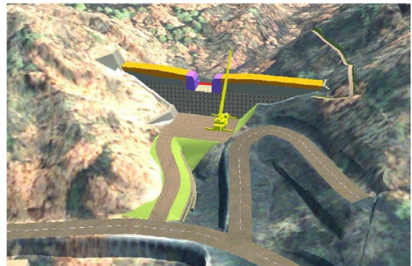
【STEP04-4】 袖部打設
