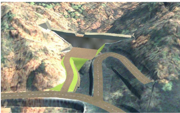
【STEP02】 本工仮設ヤード設置
