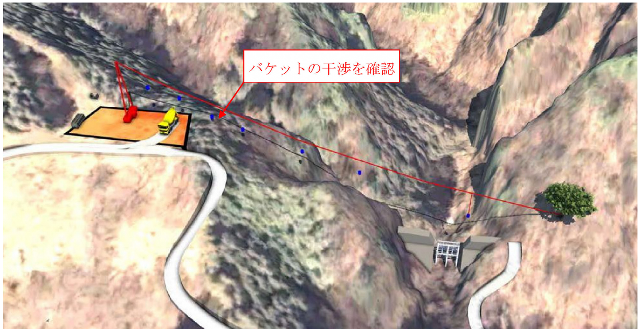
図 29 施工計画及び仮設構造物設計において活用する BIM/CIM モデルの例（2）（詳細度：300）
