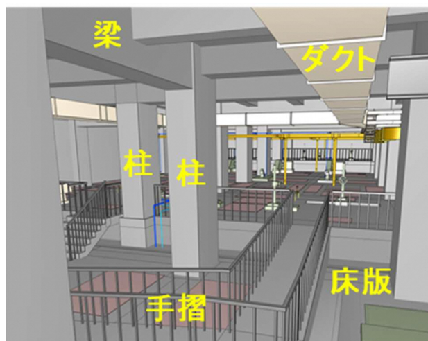
図 24 各部材によるモデル作成例
