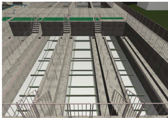
図 28 設備モデル（機械・電気）の例（LOd : 30 相当）
