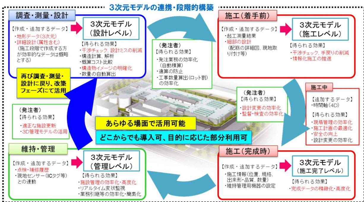
図2 マネジメントサイクル各工程におけるBIM/CIMモデル利用
