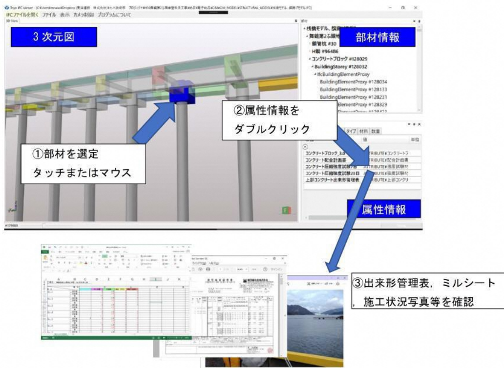
図 25 工事完成図（主要資材情報含む）において活用する BIM/CIM モデルの例
