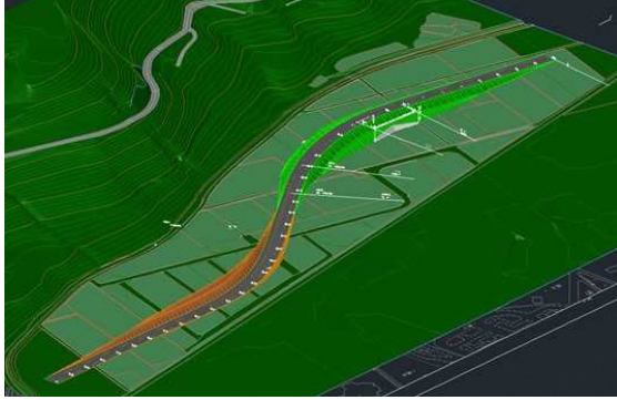
(a)3次元投影図への寸法、注記等の付与例
