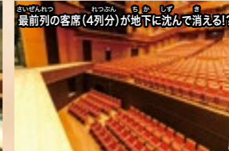
最前列の客席(4列分)が地下に沈んで消える? 舞台前の一部が下がる部分を「奈落」と言います。深さは4.65m、オペラやバレエの公演時には席が取り外され、オーケストラが演奏する場所になります。
