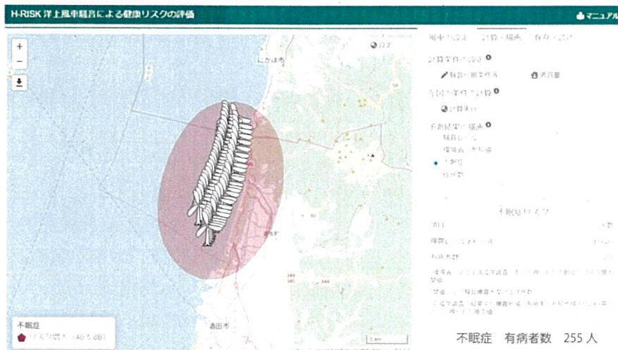
田嶋順太 北海道大学 助教 公益社団法人日本騒音制御工学会 学会誌 騒音制御 46巻の176頁 発表されたソフトウェア「H-リスク」に、遊佐風力発電 計画 のデータ 15MW 52基を 約2KM にインプットして求めた値
