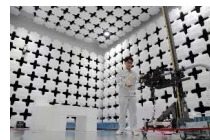
電波暗室での試験
