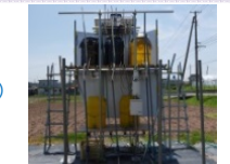
日射制御型自動灌水装置を用いた技術確立
