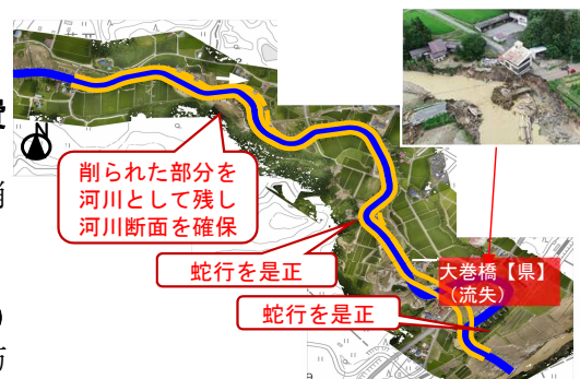
令和4年8月の大雨で被災した小白川の改良復旧（飯豊町）
