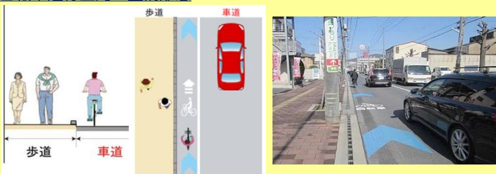
自転車と自動車とが車道内で混在通行する、**車道混在型**で整備します。
