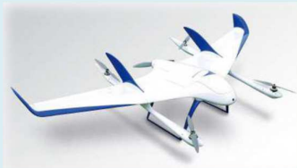
広域調査可能なドローン (航続距離50km、最高速度100km/h)
