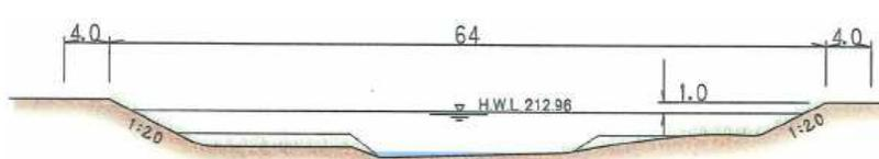
河川整備計画断面図 (吉野川合流点から上流0.3km)
