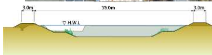
河川整備計画断面図 (下流側)
