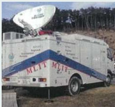
Ku-SAT(小型可搬衛星通信設備)
