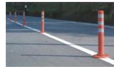
ドットラインとは・・・主に車線逸脱防止や速度抑制のために、カーブ区間や交差点の手前、歩道のない狭い道路の路側帯と中央線の内側に引いた点線状の路面表示のこと。〔P2 写真 参照〕
