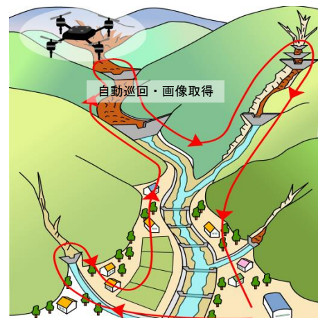
図 5.2-12 UAVを活用した施設点検 ※国土交通省資料を参考に作成
