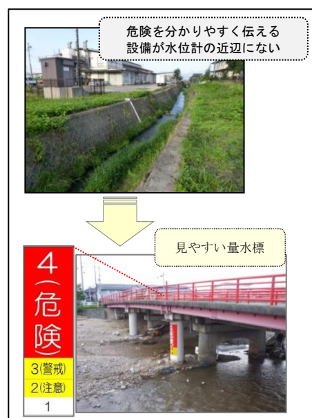
図 5.1-5 見やすい量水標の設置例
