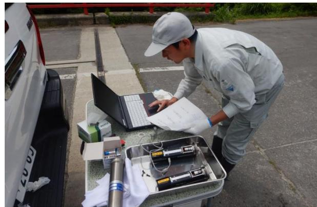
○ポータブル水質計による濁度計測
