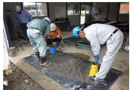
コンクリートの試し練り
