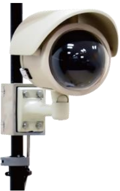
設置した簡易型河川監視カメラ
