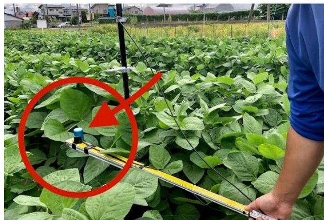
センサーを枝豆の群落の中に入れて、地表0cmから80cmまでの光の量を計測します。
