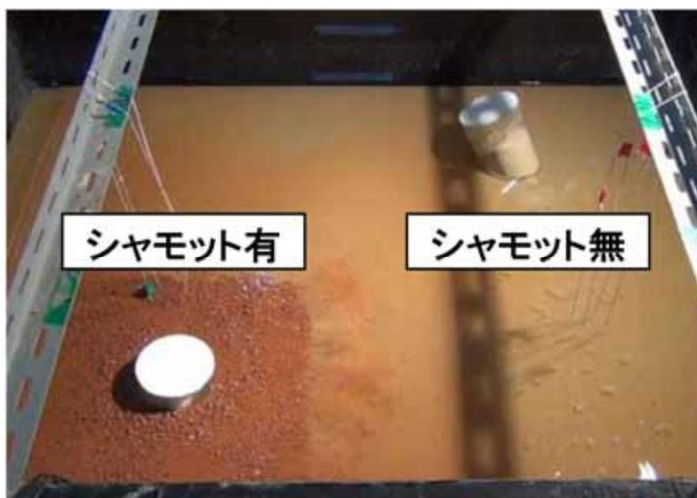
注：写真左がマンホールの回りに規格外瓦破砕品（シャモット）を保護材として使用し、液状化による浮き上がりが抑えられたイメージ。
