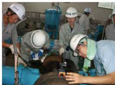
カップリングの振れ計測
