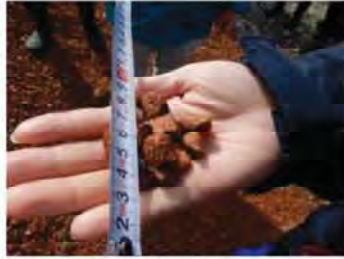
瓦を20mm以下の粒状になるまで砕いて粒度調整したもの
