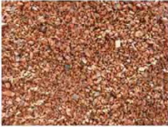
瓦を20mm以下の粒状になるまで砕いて粒度調整したもの
