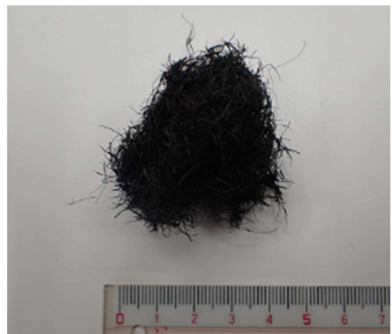
図4 30日程度使用し劣化した黄銅ファイバー
