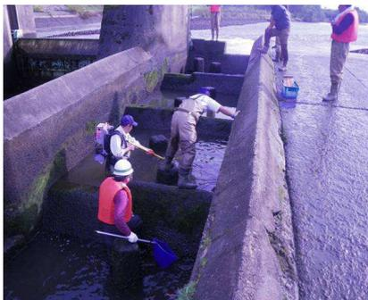
図2 電気ショッカーによる魚道内調査
