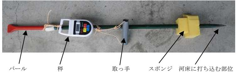
図2 河床の貫入度(固さ)を計る器具
