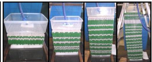
図 3 実験 3、高さを変えた曝気試験
