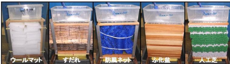
図 2 実験 2 に供した 5 種類の曝気材
