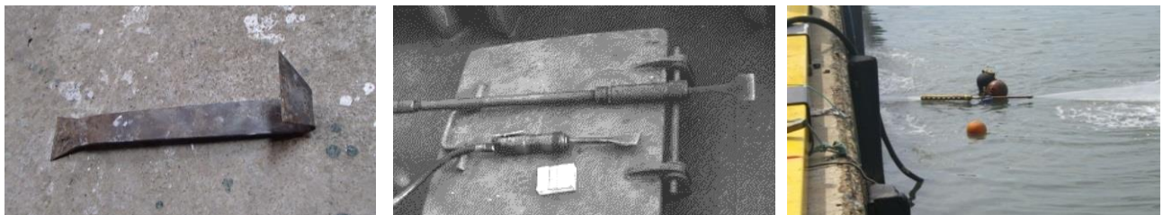
写真2 各清掃方法で用いた器材（左：スクレーパー、中央：エアチッパー 粗、右：高圧ジェットポンプ）
