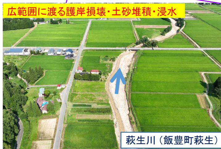
護岸損壊(120m)、市道橋流失
