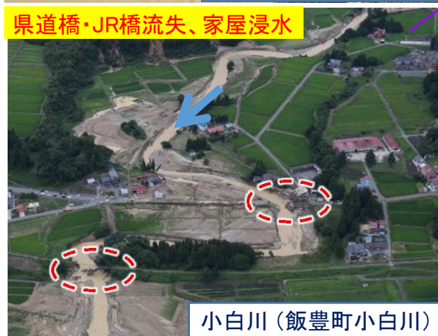
広範囲に渡る護岸損壊・土砂堆積・浸水
