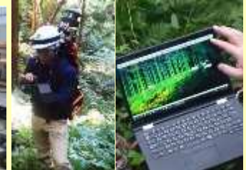
地上レーザ測量
