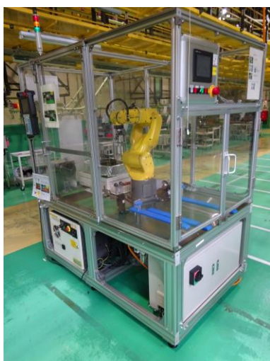
▲ 稼働中のゲーティングロボット
